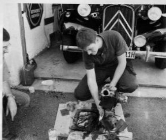
Ganz wichtig vor der Montage der neuen Zylinderkopfdichtung - penibles Säubern der Auflageflächen
