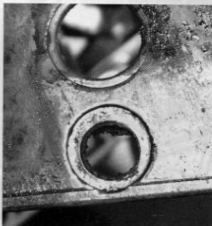
rechts: unten die Öffnung für den Zentrierstift, die eigentlich 16 mm sein sollte. Hier sieht man deutlich den Abdruck, den der Zentrierstift hinterlassen hat.
