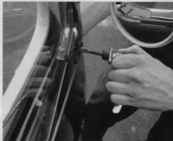
oben: Hier sieht man deutlich die beiden zueinander verdreh- ten Vierkantlöcher. Links (Außenseite) ist fest, rechts (Innenseite) ist beweglich
