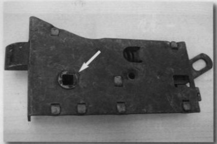
oben: Hier sieht man deutlich die beiden zueinander verdreh- ten Vierkantlöcher. Links (Außenseite) ist fest, rechts (Innenseite) ist beweglich
