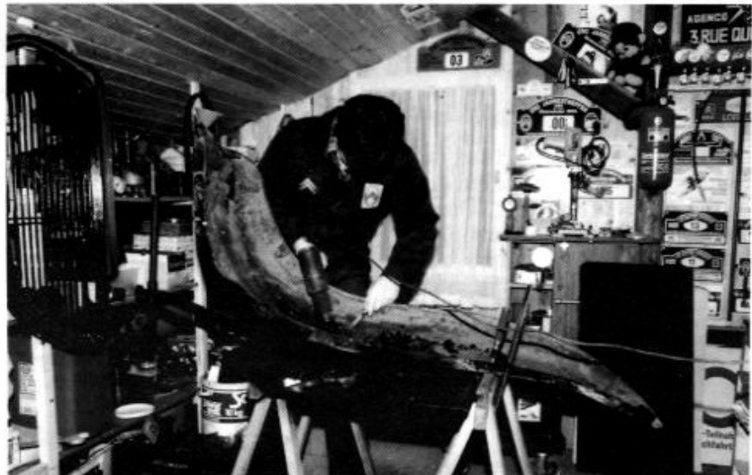
Mühselig, das Entfernen des Unterbodenschutzes
