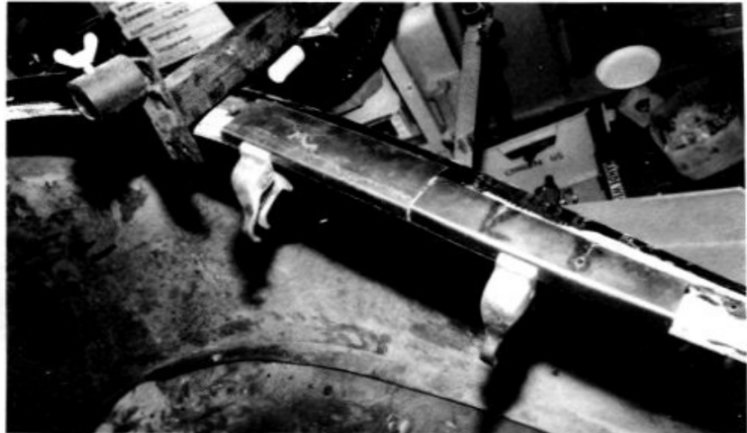
Neue Formbleche, selbst gedengelt, am vorderen Kotflügel
