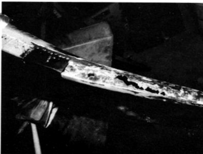
Riesenlöcher klafften in den Kotflügeln Vorne genauso ...
