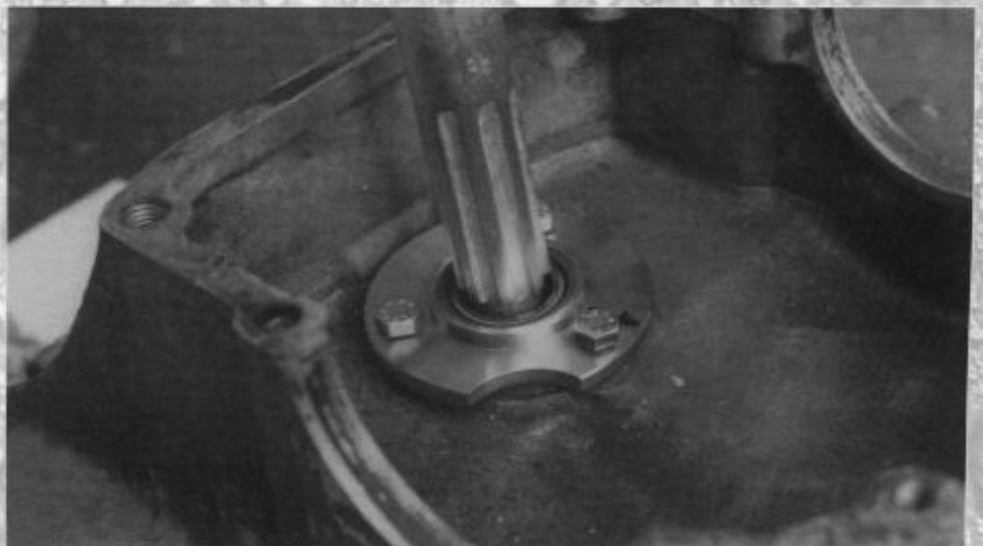
Unten: Beim Zusammensetzen von Getriebe und Glocke ist Vorsicht geboten. Der empfindliche Simmerring könnte beschädigt werden.
