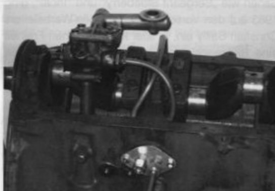
Bild 3: Die 2. Ölleitung mit dem Motorgehäuse verschrauben und zur Verschraubung an der Verschlussplatte führen.
