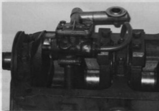
Bild 2: Ölwanne entfernen, damit die 10mm starke Ölleitung frei liegt
