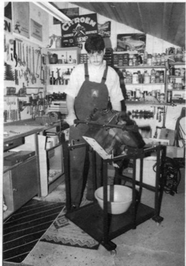
Der Motor wird um 180° gedreht
