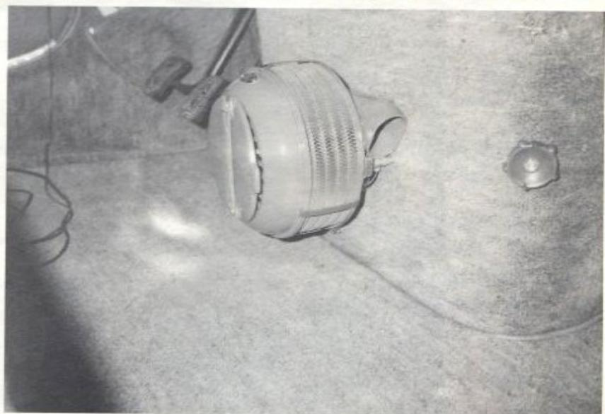
Schlauch von der Heizung wird im lockeren Bogen zum unteren Anschluß des Ventils geführt und mit einer Schlauchschelle befestigt (Handbremshebelweg beachten). Jetzt müssen nach Ablassen der Kühlflüssigkeit die Wasserpumpe und der Wasserpumpenboden abgebaut werden.
