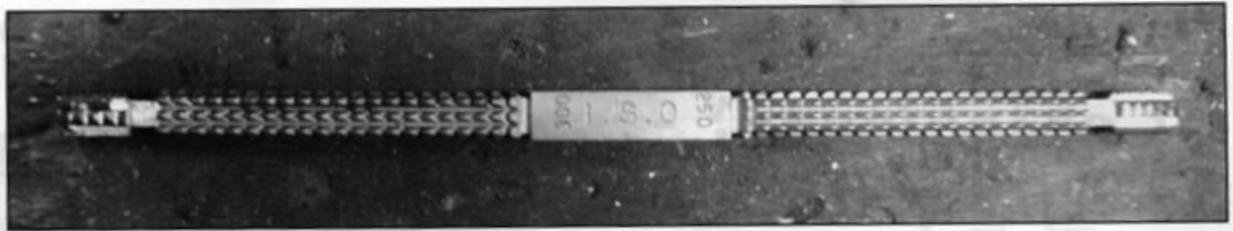
oben: Die Alternative zu den vielfältigen Gewindebohrern und Schneid-eisen: Gewindefeile
