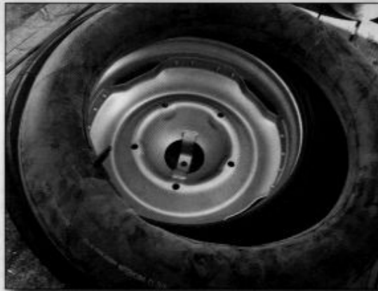
Die Montage des Schlauches und des Reifens
