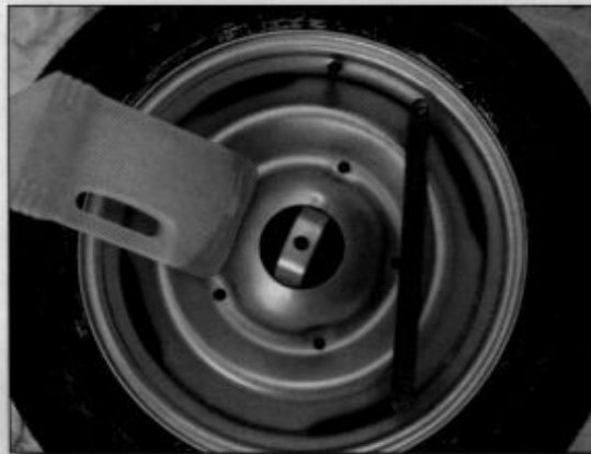
Fertigstellung mit kleinem Montiereisen und Schmierseife
