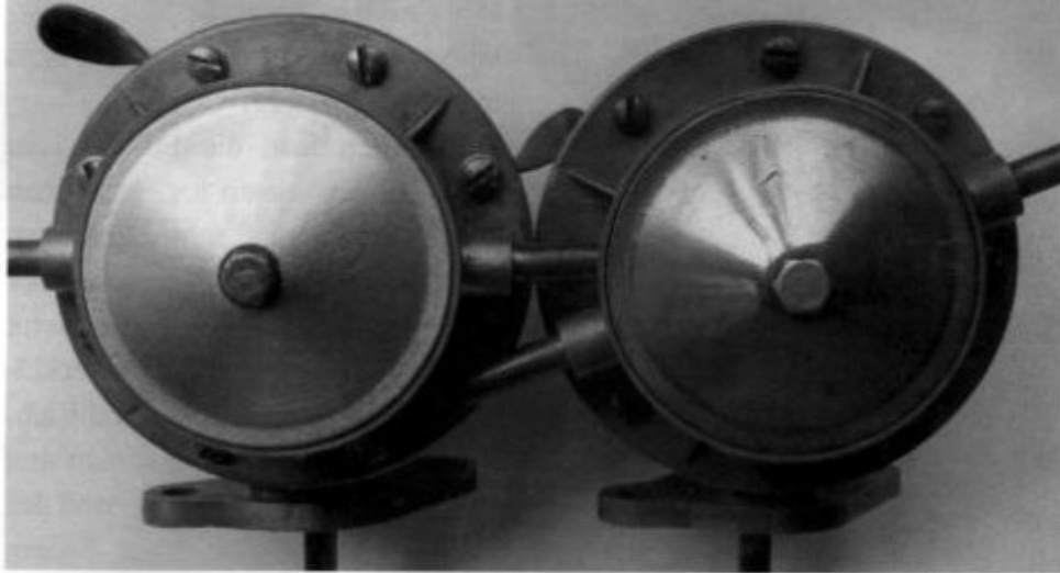
Hier links die alte Membran. Ist diese undicht, fördert die Pumpe keinen Sprit. Schlimmer noch ist, daß Benzin in den unteren Pumpenkörper läuft und von da aus in den Motor-Innenraum. Die Folgen können fatal sein.
