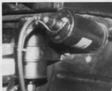
Panzerzündspule von BOSCH
