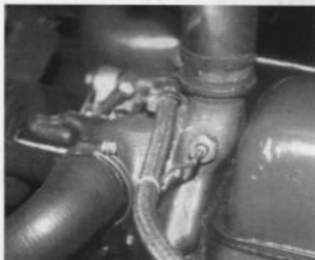
Kühlwasser-Thermometeranschluss an der Wasserpumpe
