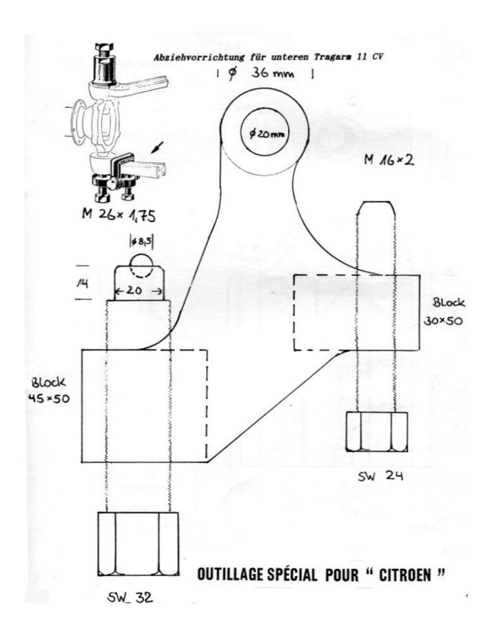
Der Abzieher ist im Vergleich zu dem Original geändert (vgl. oberes kleines Bild)
